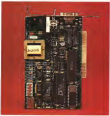
Vista d'insieme della scheda modem: compatte e organizzati l'un ordine. Particolare degno di nota il dip switch AMP con i contatti argentati.
